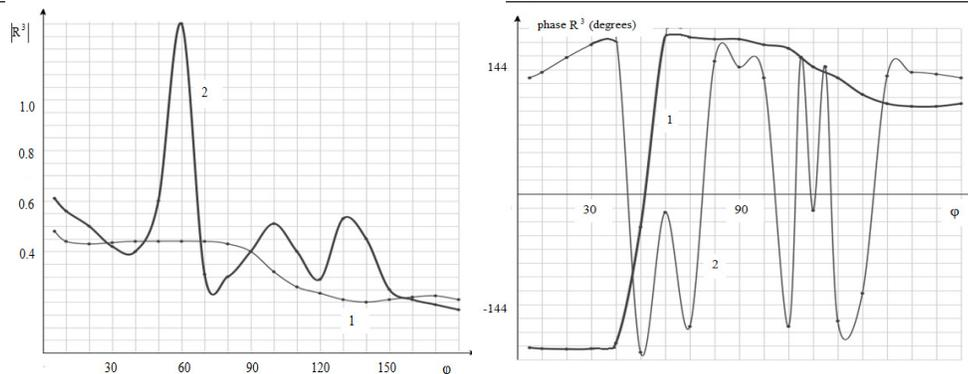
Fig. 4. Dependence  $R^3$  on the phase shift  $\varphi$ :  $N = 5$ ;  $b=0.6\lambda$ ;  $a=0.1\lambda$ ;  $rz1=0.25\lambda$ ;  $rz2=0.45\lambda$ ;  $c=0.15\lambda$ ;
